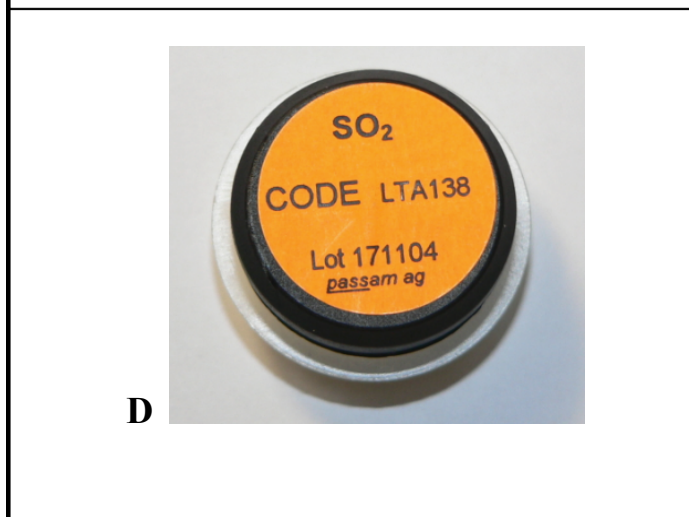
1 pav. Pasyvieji sorbentai ir jų tvirtinimo įrenginys.
