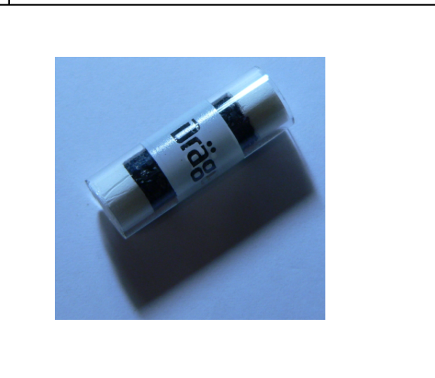
1 pav. Pasyvieji sorbentai ir jų tvirtinimo įrenginys. Apsauginis cilindras skirtas apsaugoti eksponuojamus pasyvius sorbentus nuo kritulių, vėjo, dulkių ir kt. nepalankių veiksnių ( A ). Pasyvieji sorbentai (kaupikliai), skirti oro teršalų koncentracijai aplinkos ore nustatyti: azoto dioksidui ( B ); sieros dioksidui ( C ); lakiesiems organiniams junginiams – benzenui, toluenui, etilbenzenui, ksilenui ( D ).
